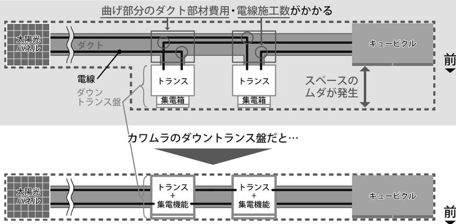
※ 他社製のダウントランス盤でも地中埋設配線にすることで側面出線が可能ですが、施工コストが上がります。
